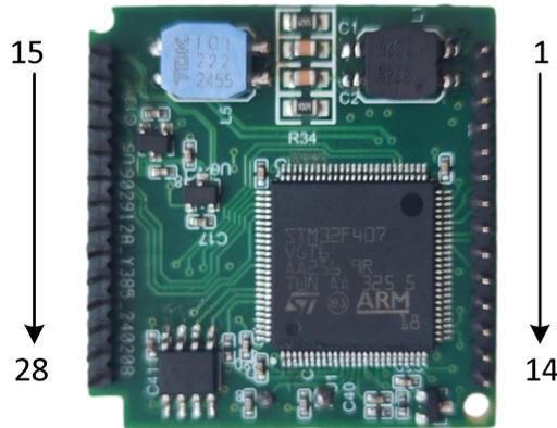
图 4 MC0312L 嵌入式核心模块接口定义
