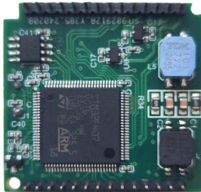
图 1 MC0312 Ethernet-AP 嵌入式核心模块
