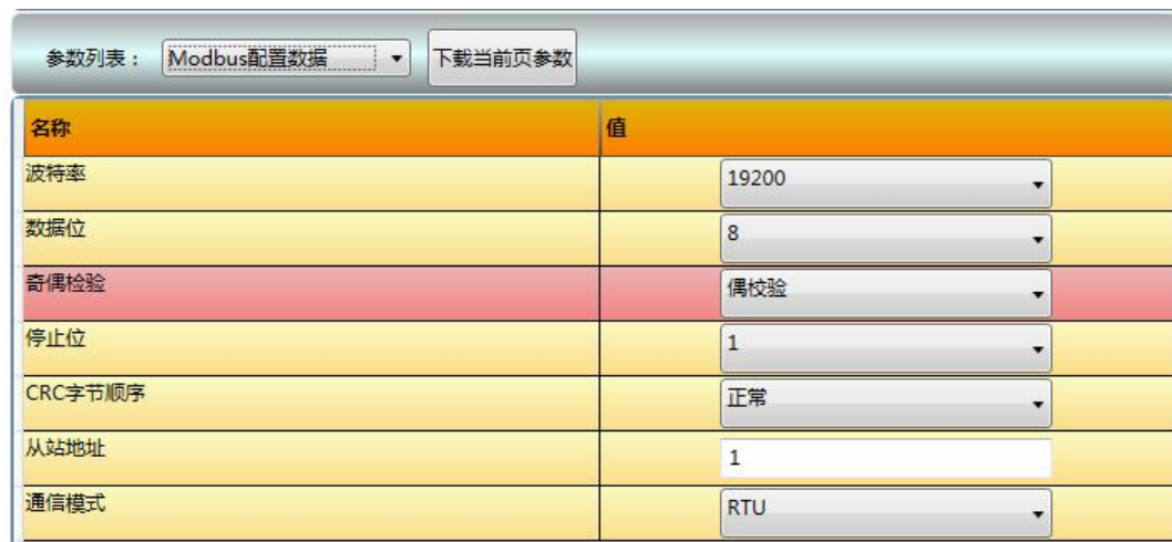
图 7 Modbus 参数配置举例
