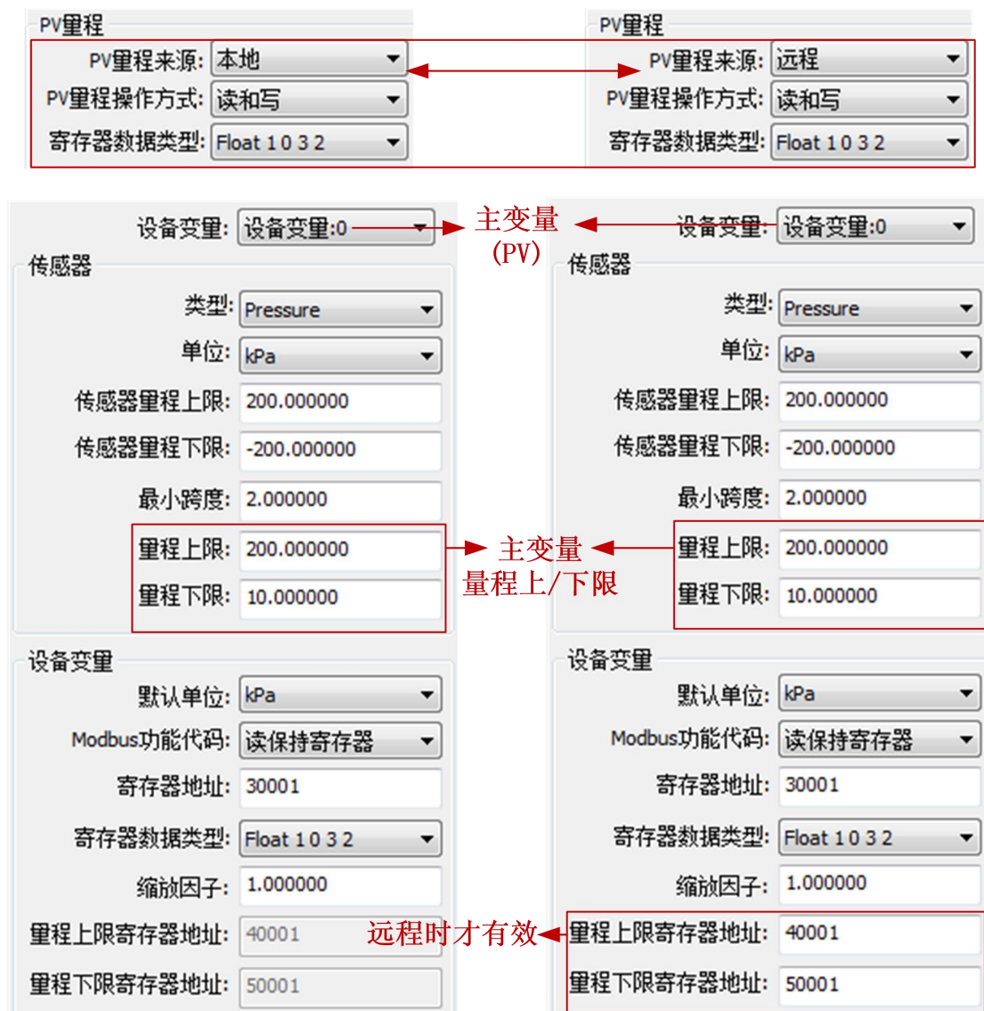
图 3.5 PV 量程操作实例
